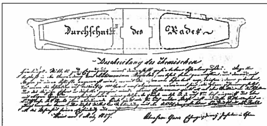
■ 2. ábra. A Ganz-szabadalomban a kettősfalú kerék keresztmetszetének rajza
