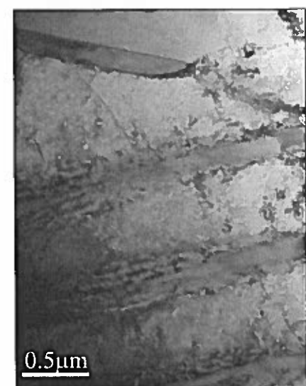
9. ábra. A kéreg felszínén kialakult nanokompozitban, a ferrit/cementit határán induló és sűrűsödő diszlokációkkal
